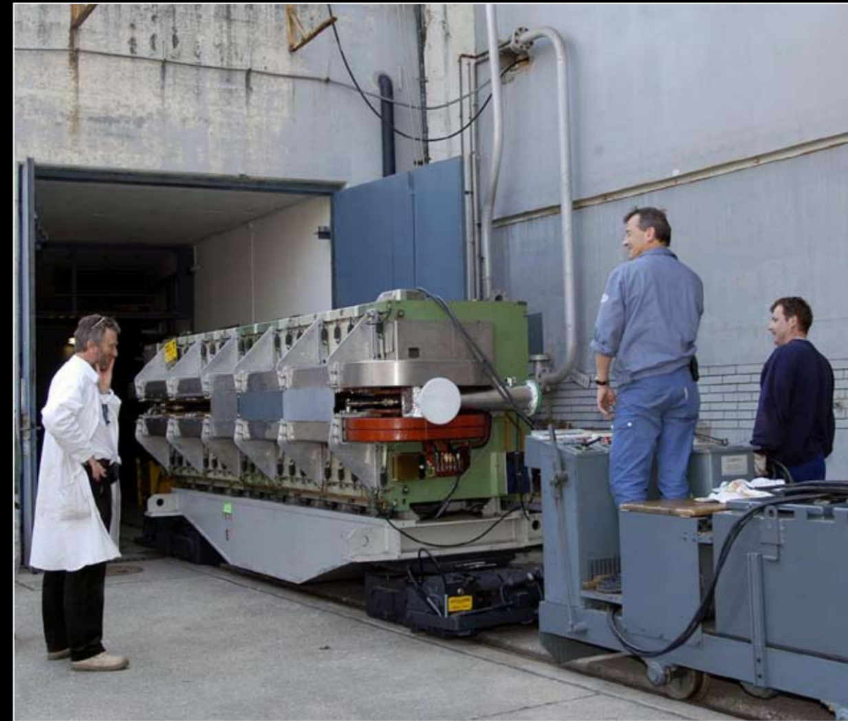
In July 2001 the PS locomotive is brought back into service after a break of over 10 years. It makes a full circuit of the PS on rails, displacing the 30 ton magnets on their way to be renovated. En juillet 2001, la locomotive du PS est remise en service, après plus de dix ans d'arrêt. Elle emprunte les rails qui font le tour de l'accélérateur pour déplacer les aimants de 30 tonnes qui devront être réparés.
